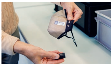
Die Maske besteht aus einem mehrlagigen Textil, Elektroden und einer kleinen Batterie (© ZHAW, Hannes Heinzer).
