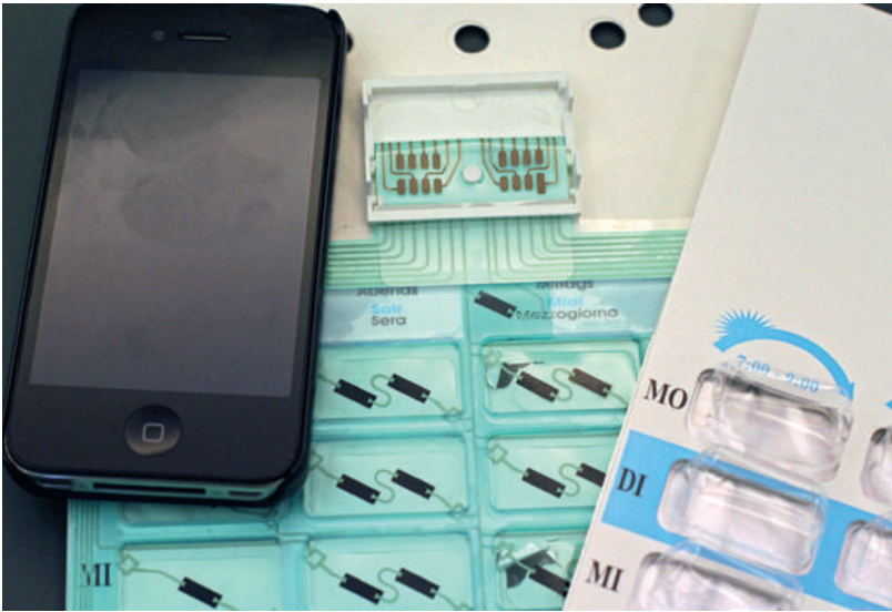
Mit Elektronik aufgerüstete Medikamentenpackung: Wird eine Tablette herausgelöst, löst dies ein Signal aus, das von einem Smartphone empfangen und weitergeleitet werden kann. Dies wird etwa für Adhärenz-Studien genutzt. (Foto: Adrian Ritter)
